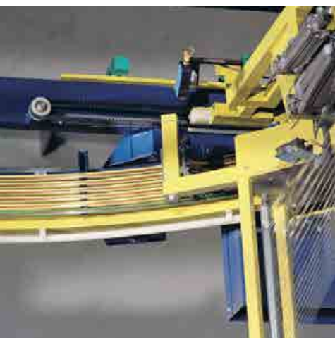
Мы изменяем направление! Одиночные гибкие шинопроводы программы 0815 используются для работы упаковочной машины.
