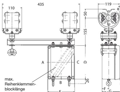
**Achtung:** Der Anschlusskasten muss mit einer Schutzleiter-Reihenklemme Typ EK 2,5 N PA geerdet werden!
